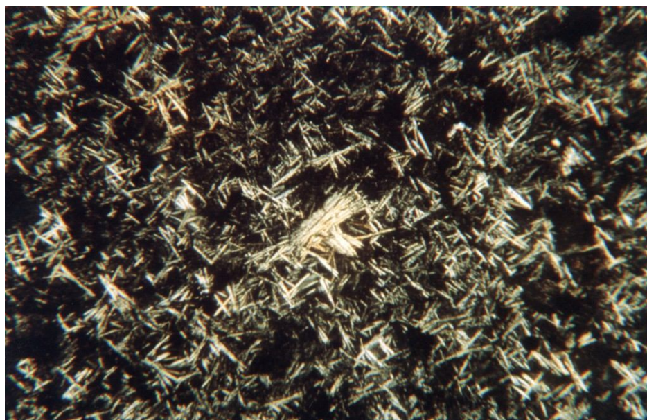
Fot.19 Próbką Lu 1.3. Łupek z Krobicy po spieczeniu: T=1880^{\circ}\text{C} i P=400 bar. Centralna część pastylki. Beładnie układające się nowopowstałe fazy mineralne o pokroju drobnych igiełek. Mikroskop polaryzacyjny, polaroidy X, powiększenie 60x.
