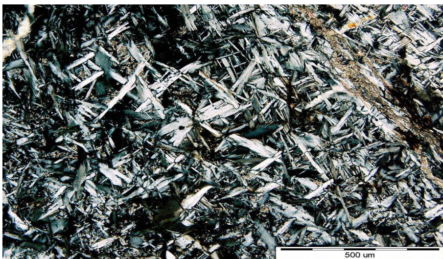
Fot.1 Serpentynit z Nasławic, skała naturalna. Mikroskop polaryzacyjny, polaroidy X, powiększenie 60x.
