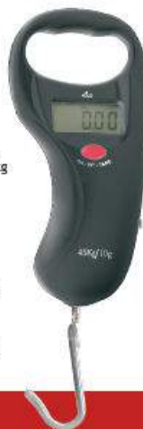
99-WA-025 Waga elektroniczna do 25 kg * jednostki pomiaru: kg, jin, lb, oz * dokładność pomiaru: 0-10 kg d=5 g, 10-25 kg d=10 g * zasilanie: baterie 2x AAA (w zestawie) - DODATKOWE FUNKCJE: * podświetlany ekran * czujnik temperatury * automatyczne wyłączenie * funkcja zerowania/ taro- wania * wskaźnik niskiego poziomu baterii * wskaźnik przeciążenia
