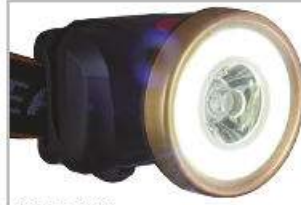
99-LM-009 Latarka czołowa DUAL XP 150 lumenów/ 1 biała dioda LED 3W + 1 biała dioda COB 3W LED 100% mocy / COB-światło rozproszone 100% mocy / COB-światło rozproszone pulsacyjne / wyłączenie 3 x AAA baterie (brak w zestawie)
