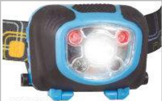
99-LM-029 Latarka czołowa SMART SENSOR 80 lumenów/ 1 biała dioda LED 3W + 2 czerwone diody LED. Funkcja standard: światło białe / czerwone diody LED / czerwone diody LED - światło pulsacyjne / wyłączenie. Funkcja sensor: uruchamiana 3 sekundowym przytrzymaniem przycisku 3 x AAA baterie (brak w zestawie)
