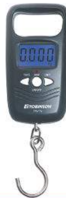
99-WA-026 Waga elektroniczna do 45 kg * jednostki pomiaru: kg, lb * dokładność pomiaru: d=10 g * zasilanie: baterie 2x AAA (w zestawie) - DODATKOWE FUNKCJE: * podświetlany ekran * automatyczne wyłączenie * funkcja zerowania/ taro- wania * zapamiętywanie ostatniego pomiaru * wskaźnik niskiego poziomu baterii * wskaźnik przeciążenia
