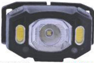
99-LM-034 NEW Latarka czołowa z czujnikiem ruchu materiał: ABS, dioda LED 3W 120 Lumenów, funkcja świecenia światłem strumieniowym oraz rozproszonym, światło białe i czerwone, wyłączany sensor ruchu, zasilanie: wbudowany akumulator 800 mAh, waga 62 g
