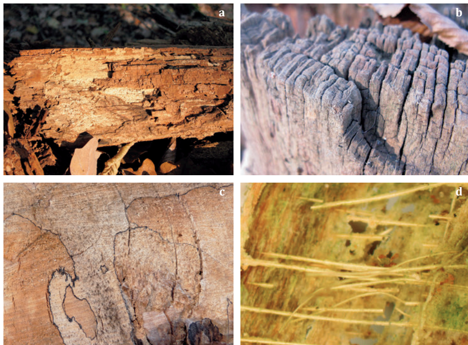
Różne typy rozkładu drewna: a) brunatna zgnilizna drewna iglastego, b) brunatna zgnilizna drewna liściastego, c) biała zgnilizna, d) rozkład pstry z czasowym opóźnieniem destrukcji promieni rdzeniowych drewna (fot. Z.S., M.W.)
