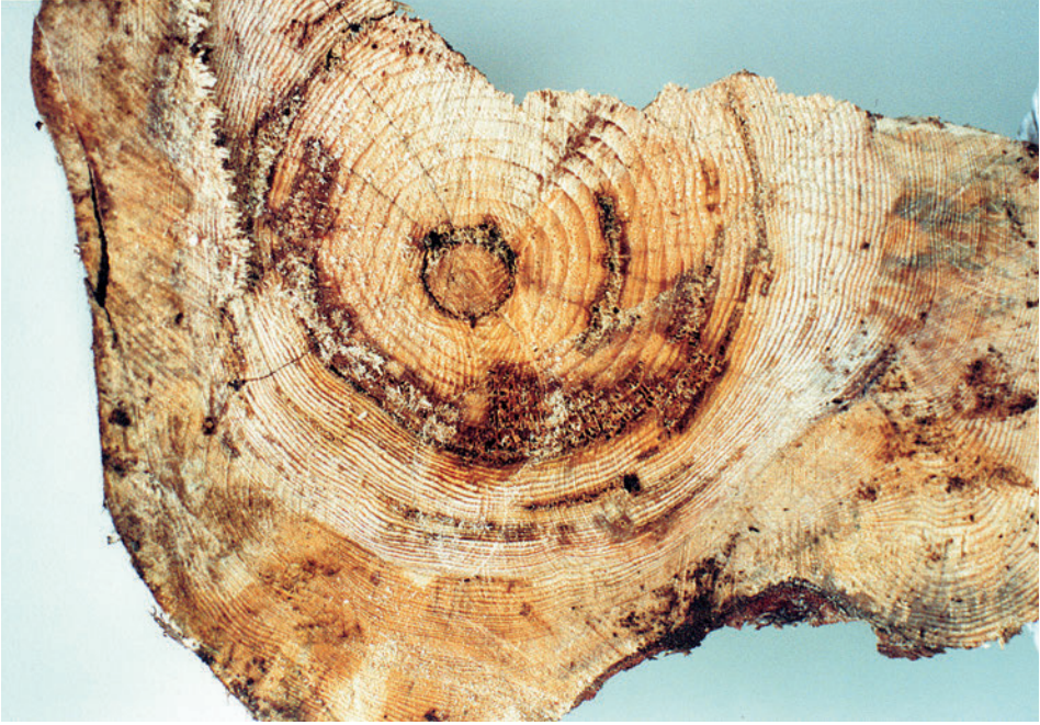
Efekt oddziaływania enzymów grzybowych na celulozę i ligninę (fot. Z.S.)
